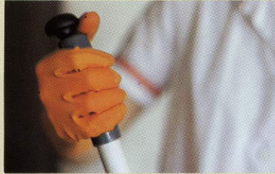
Le débit de la solution désinfectante se règle pendant le travail au moyen du champignon de dosage.
